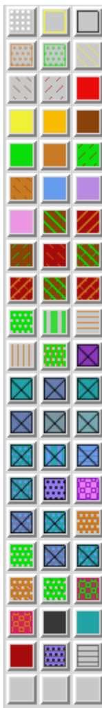
Figura 1. La barra de herramientas para la versión Tcl/Tk de Magic. La imagen mostrada corresponde al archivo de tecnología SCMOS el cual es la tecnología por defecto, y utiliza el paquete gráfico OpenGL.
